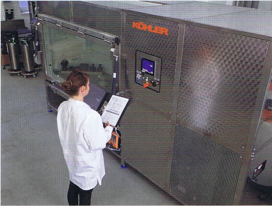
Abb. 1: Das IGOS hat seine Prüfausstattung jüngst um eine neue Universalprüfkammer erweitert, die den kompletten Vorgang der Korrosionsprüfung auf einer Maschine ermöglicht
