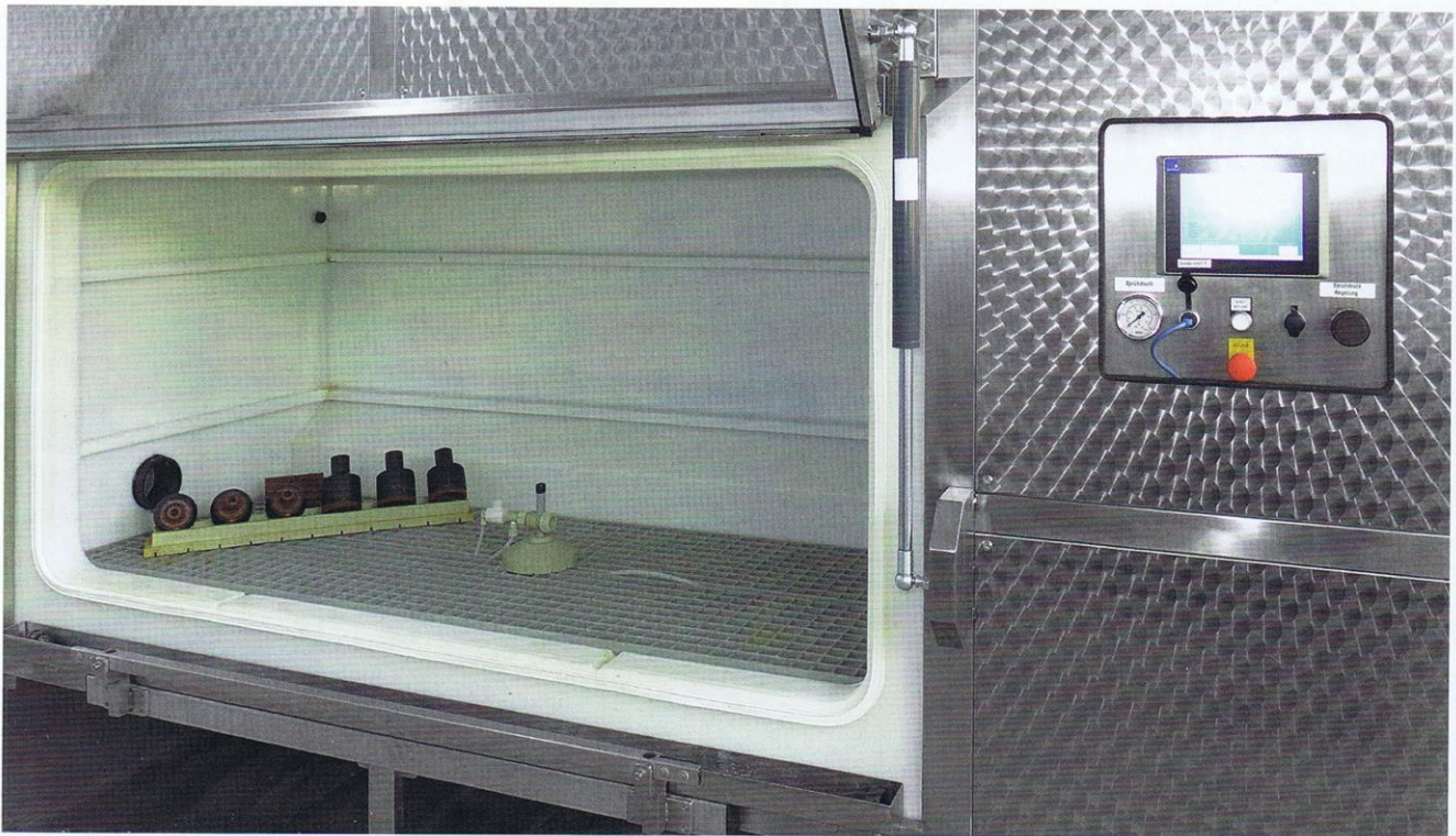
Abb. 2: Der Innenraum der Kammer ist mit einem speziellen witterungsbeständigen Kunststoff ausgestattet und verfügt über ein großes Volumen, so dass Prüfobjekte verschiedener Größe und selbst komplette Baugruppen den Tests unterzogen werden können
